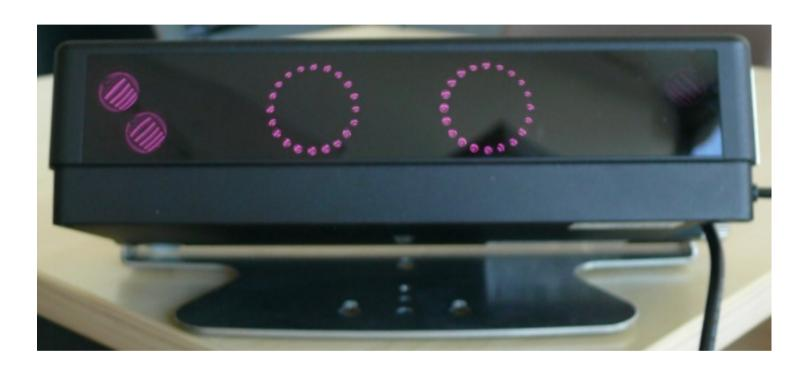
Ein Eyetracker besteht aus **zwei Komponenten**, einem **Nah-Infrarotstrahler**, der Licht in das Gesicht der Testperson strahlt und einer **Kamera**, die die entstehenden Reflektionen aufnimmt.
